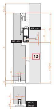
Вариант установки при расстоянии **18мм** от стены с **TRACK 1490.**
